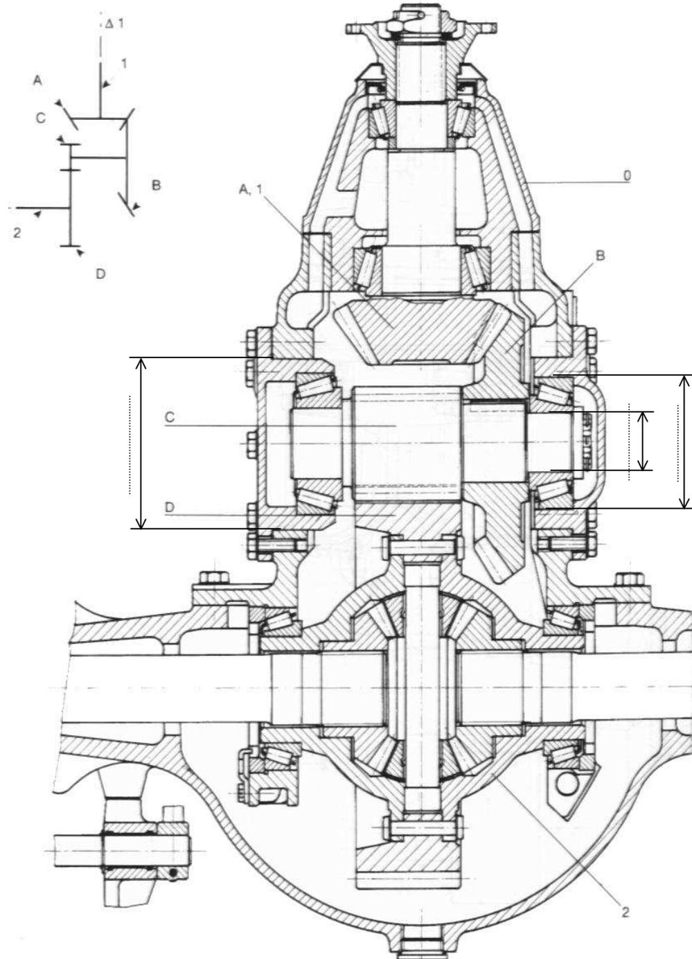
L'arbre intermédiaire portant les roues B et C est guidé en rotation par 2 roulements :
