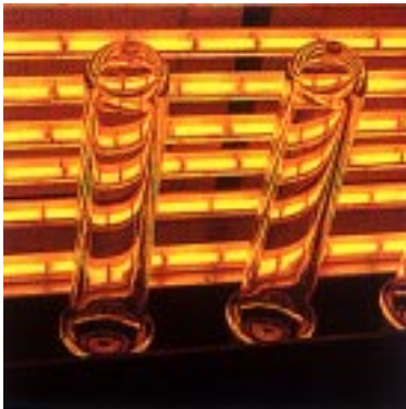
Passage des préformes dans le four de réchauffage avant soufflage
