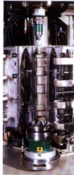
Moule porte feuille ouvert: on distingue le système de verrouillage; le nez de soufflage et la partie rapportée « fond de bouteille »
