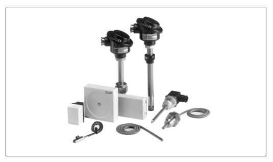
Les types AKS et ESM sont des sondes de température à résistance. L'élément sensible est en platine et la valeur de sa résistance varie proportionnellement à la température.
