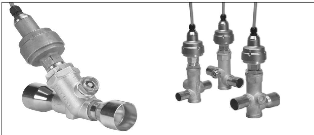
Les vannes ETS sont des vannes de détente à commande électrique conçues pour assurer une injection de liquide précise dans les évaporateurs des systèmes de conditionnement de l'air et de réfrigération.
