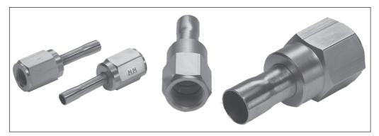
L'adaptateur flare / braser type FSA permet de transformer, de manière sûre et simple, les raccords flare en raccords à braser. L'adaptateur offre un assemblage qui combine les avantages des raccords flare et à braser, à savoir changement simple et rapide des composants pour le premier et grande étanchéité d'où risque minime de fuites pour le second.
