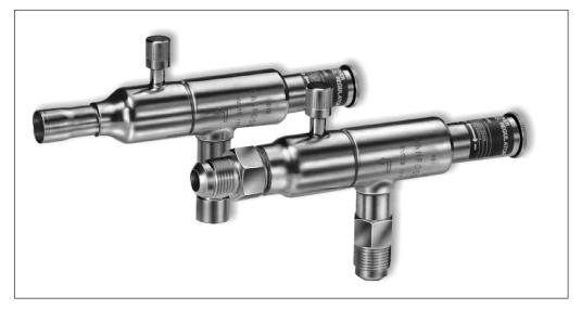
Le KVD est un régulateur de pression modulant. Il s'ouvre lorsque la pression de bouteille baisse et dérive le gaz chaud pour maintenir la pression de la bouteille à la valeur de réglage du régulateur.
