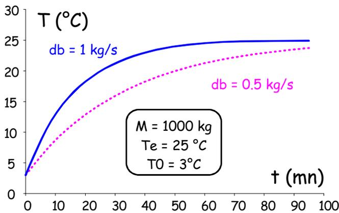
On a alors  $\frac{dT}{(T_{\text{entrée}} - T)} = \frac{db}{M} dt$ , d'où
