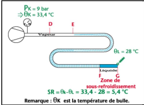
4) Les pertes de charge dans la tuyauterie de refoulement du compresseur et dans le condenseur sont négligeables.
