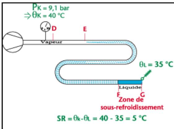
1) Les pertes de charge dans la tuyauterie de refoulement du compresseur et dans le condenseur sont négligeables.
