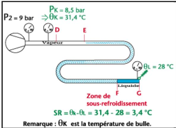
5) Les pertes de charge dans la tuyauterie de refoulement du compresseur ne sont pas négligeables, tandis que celles du condenseur sont négligeables.
