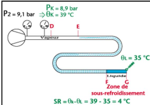
2) Les pertes de charge dans la tuyauterie de refoulement du compresseur ne sont pas négligeables, tandis que celles du condenseur sont négligeables.
