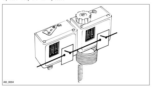
Pour les installations où les KP ne sont actionnés que très rarement (alarme) ou font office de capteurs-émetteurs pour les automates programmables PLC ou similaires, utiliser les KP avec contacts plaqués or. Ils assurent un contact correct aux très basses tensions.
