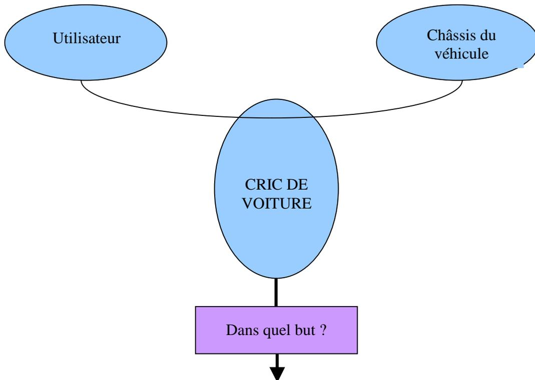
Pour permettre à l'utilisateur de changer une roue manuellement
