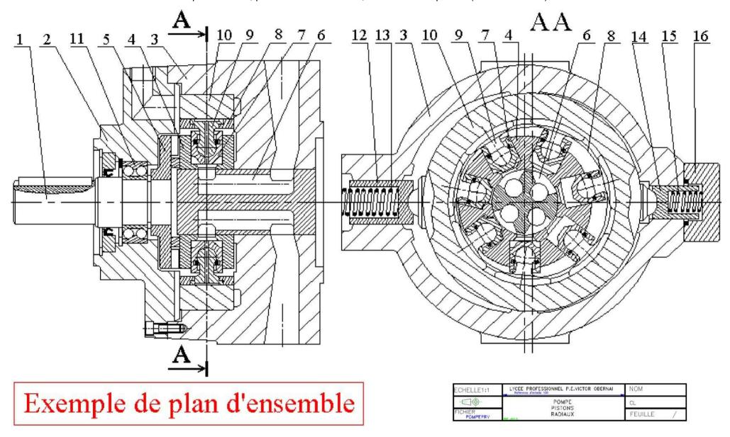
Nom Pompe hydraulique à pistons radiaux et à débit variable PJ
